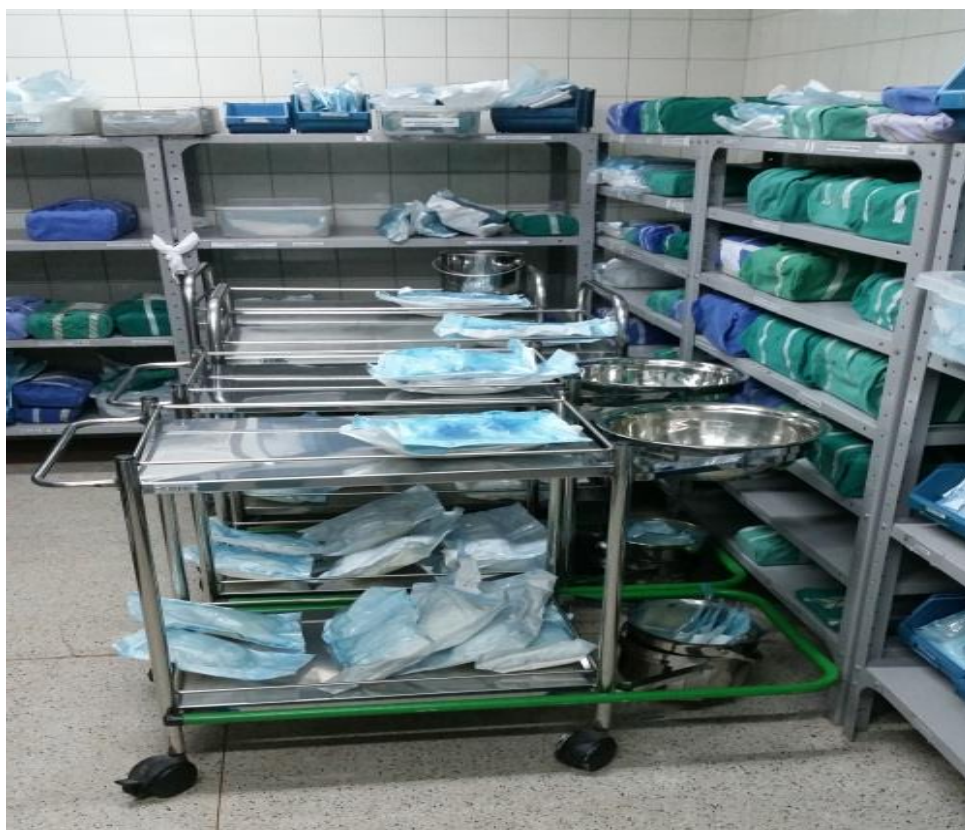
Figura 14 B - A sala de armazenamento e distribuição com equipamento de transporte com rodízio e prateleiras de material não poroso, resistente à limpeza úmida e ao uso de produtos saneantes.
