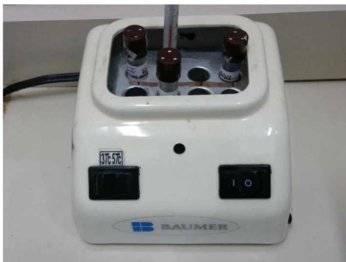
Figura 9 – Equipamento para leitura de teste biológico obsoleto, utilizado no Centro de Material e Esterilização do Hospital Geral de Palmas. Palmas-TO, 2017.
