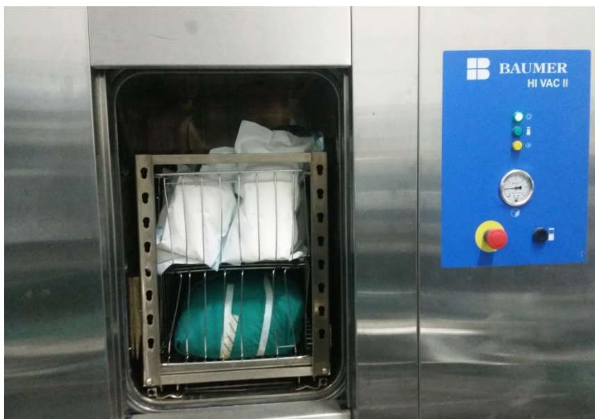
Figura 8 – Autoclave de pré-vácuo utilizada no Centro de Material e Esterilização do Hospital Geral de Palmas. Palmas-TO, 2017.
