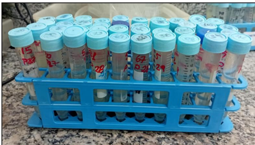
Figura 17 - Amostras armazenadas em tubos falcon 25 ml, adição das cinzas à solução clorídrica, afin de realizar procedimentos bromatológicos
