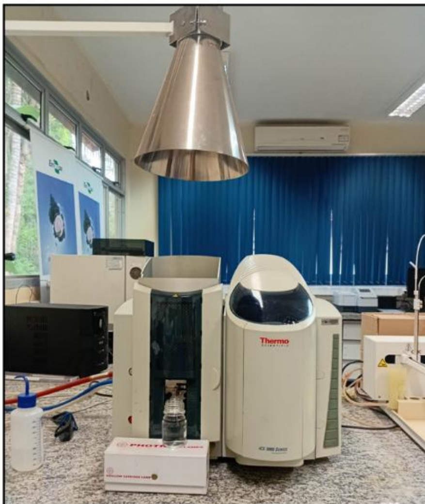
Figura 18 - Espectrofotômetro de absorção atômica - Ice 3000 series
