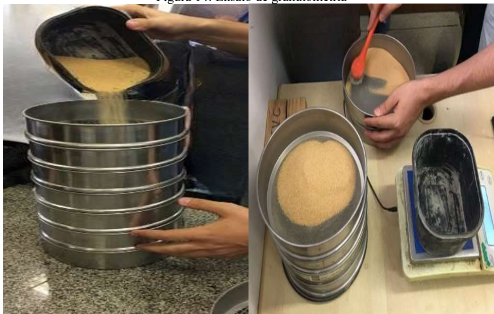
Figura 14: Ensaio de granulometria
