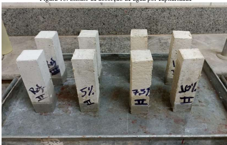
Figura 10: Ensaio de absorção de água por capilaridade
