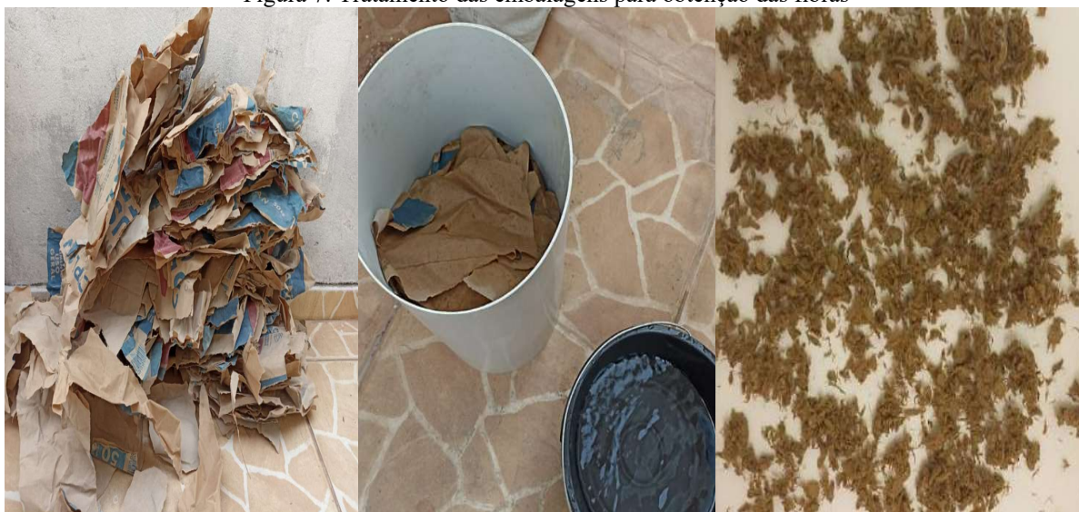
Figura 7: Tratamento das embalagens para obtenção das fibras
