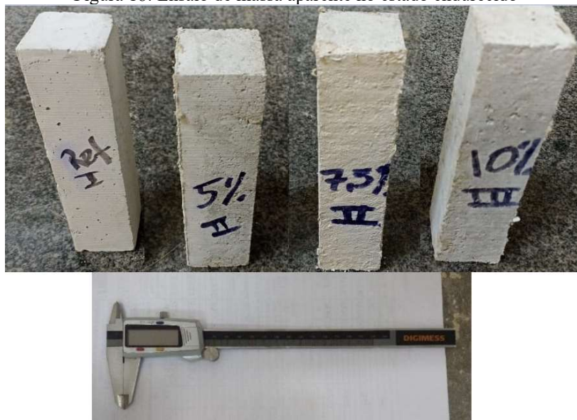
Figura 18: Ensaio de massa aparente no estado endurecido
