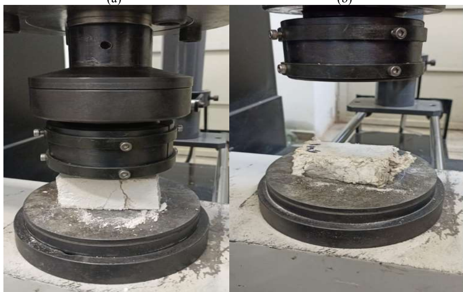
Figura 13: Ensaio de compressão (a) traço de referência (b) traço com fibras.
