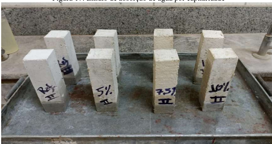
Figura 17: Ensaio de absorção de água por capilaridade
