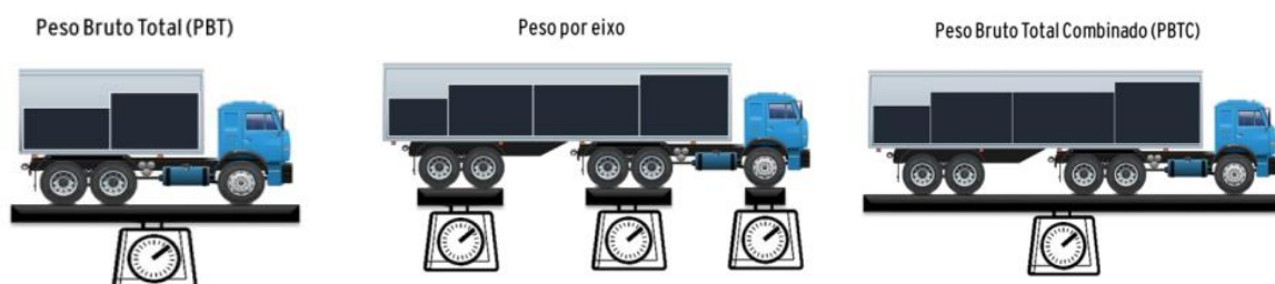
Figura 8 – Diferença entre PBT, PBTC e Peso por Eixo.
