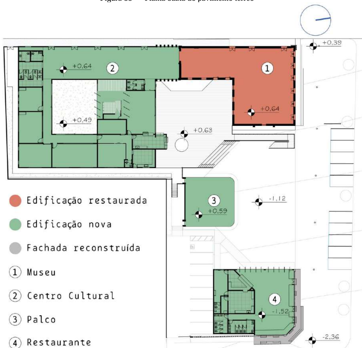
Figura 88 — Planta baixa do pavimento térreo
