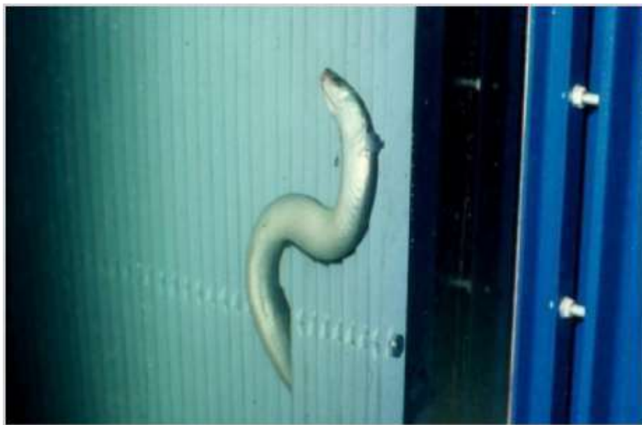
Figura 9 - Grade com barras horizontais espaçadas de 20 centímetros
