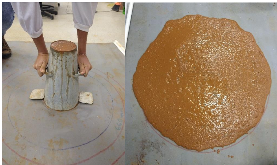
Figura 15: Determinação do diâmetro de espalhamento pelo tronco de cone de Abrams.
