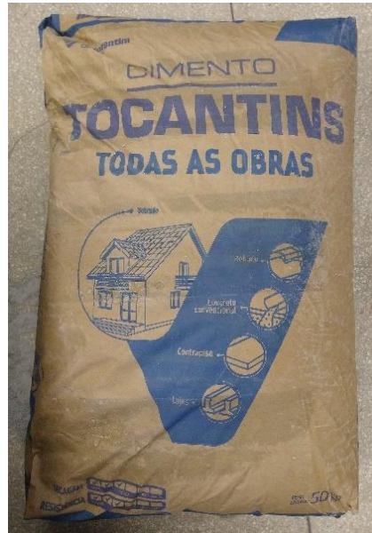
Figura 10: Cimento utilizado na produção do tijolo de SCAA.
