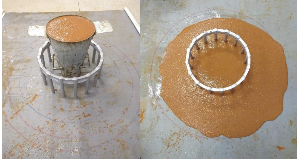
Figura 16: Determinação do diâmetro de espalhamento pelo Anel J.
