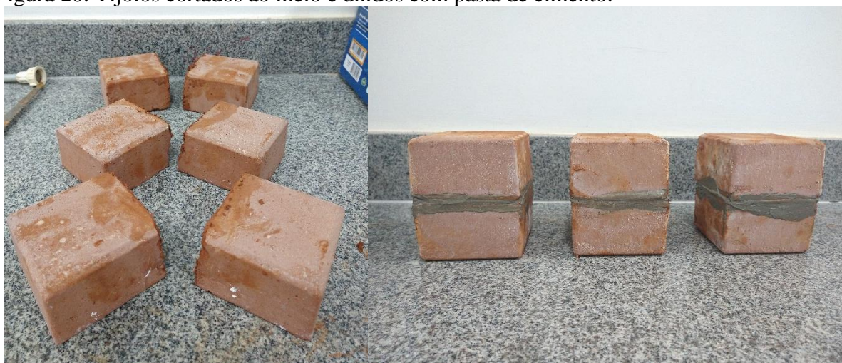
Figura 20: Tijolos cortados ao meio e unidos com pasta de cimento.
