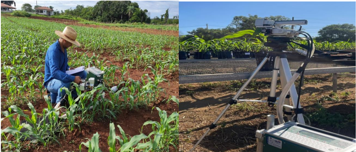
Figura 3. Equipamento IRGA –Infrared Gas Analyzer, modelo Li-6400.
