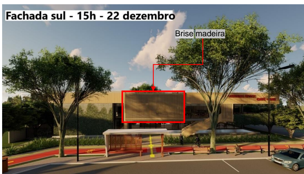
Figura 63 – Proteção solar fachada sul período da tarde
