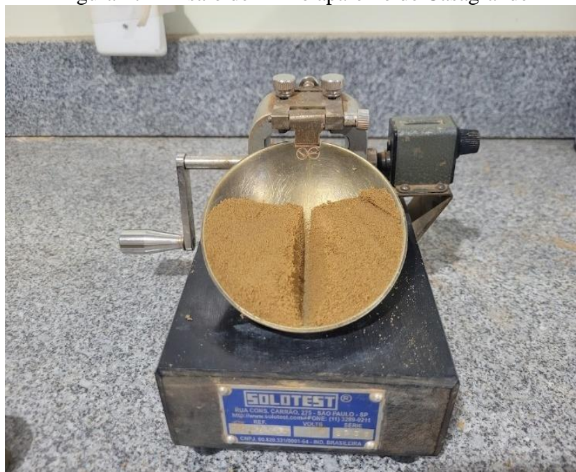
Figura 27 - Ensaio de LL no aparelho de Casagrande
