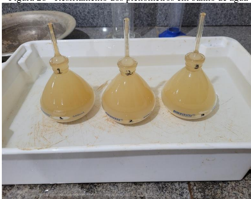
Figura 26 - Resfriamento dos picnômetros em banho de água
