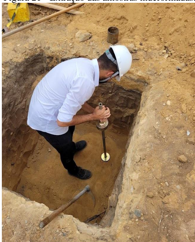
Figura 21 - Extração das amostras indeformadas.
