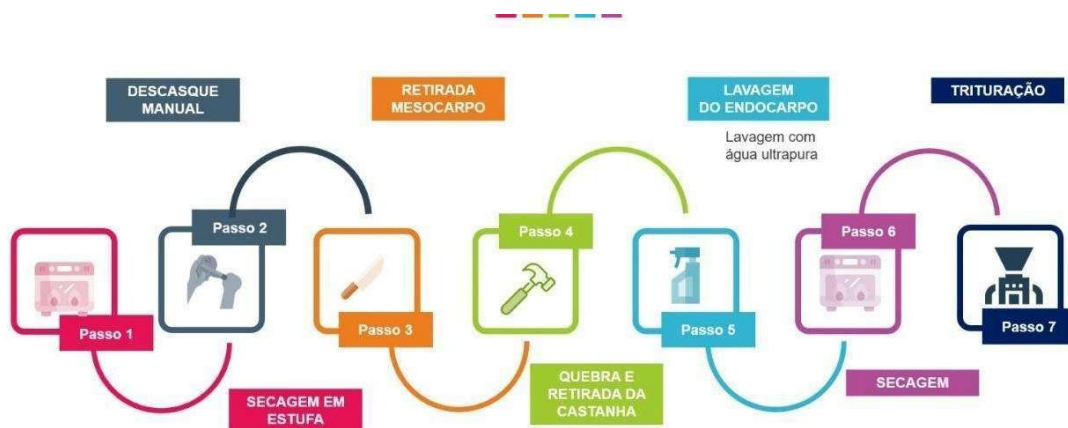
Figura 6- Fluxograma de preparo do endocarpo da Bocaiuva in natura.
