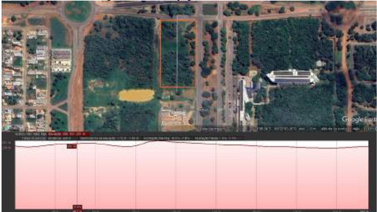
Figura 17 - Corte topográfico vertical do lote.
