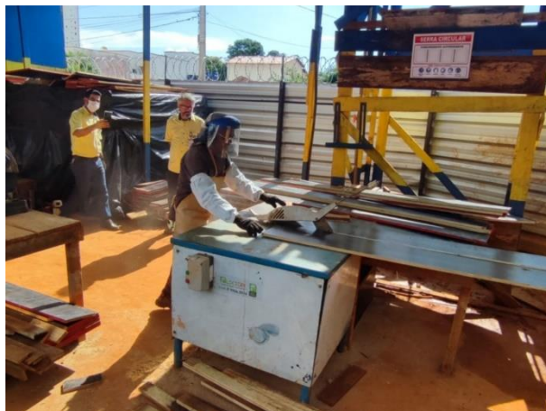
Figura 23 - Utilização da serra circular da maneira correta
