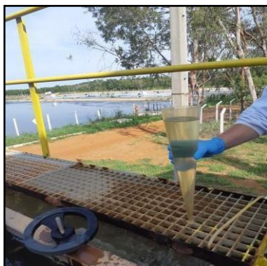
Figura 16: Coleta do efluente tratado na saída do flotador para análise de eficiência, conforme previsto a legislação.
