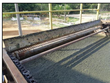
Figura 15: Material flutuante do flotador, proveniente de um processo físico-químico em que associa-se coagulante para remoção de sólidos suspensos.
