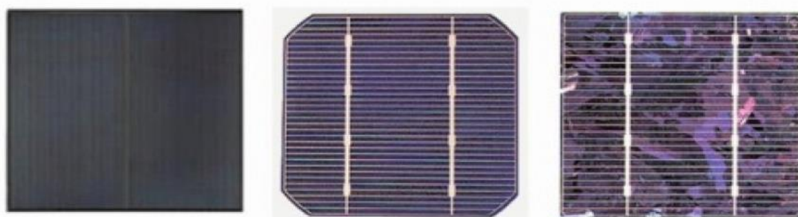
Figura 7: Esta figura está representando as células de silício amorfo, monocristalino, policristalino, respectivamente da esquerda para direita
