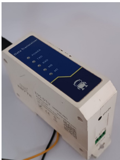
Figura A04 - - Rádio Wireless LoRa E95-DTU(400F20-485) da empresa Ebyte.
