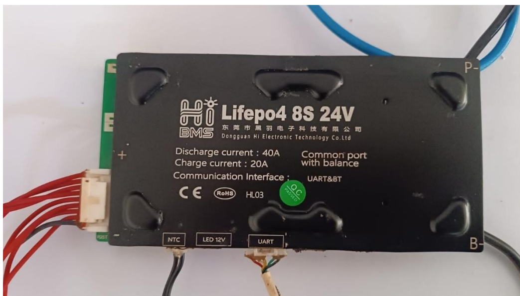
Figura A02 - - Da empresa HiBMS, também associado a empresa Daly BMS, dispositivo para utilizar em baterias LIFEPO4 na configuração 8S com 24V
