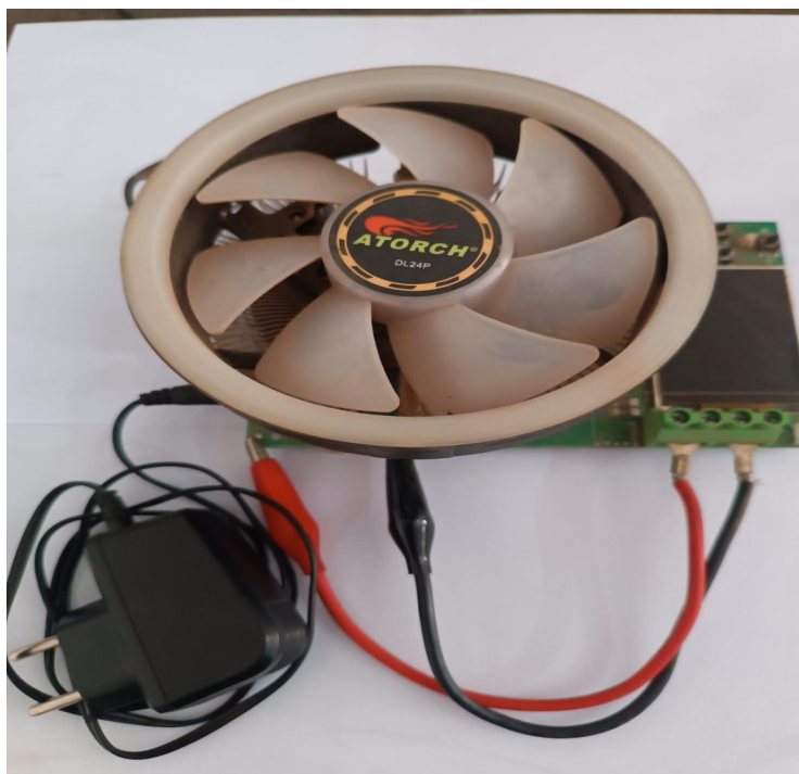
Figura A06 - - Simulador de Carga da marca Atorch DL24P – 180W, responsável por fazer a descarga da bateria com variáveis ajustáveis, como corrente, potência e tensão contínua, mostrando tempo de descarga, com valores de tensão de corte para evitar o afundamento das baterias
