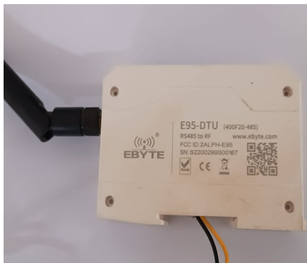
Figura A04 - - Rádio Wireless LoRa E95-DTU(400F20-485) da empresa Ebyte.
