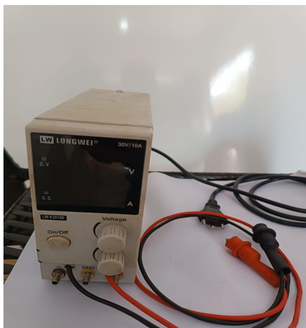
Figura A07 - - Fonte Alimentação Controlada LW LONGWEI 30V/10A – LW-K3010D
