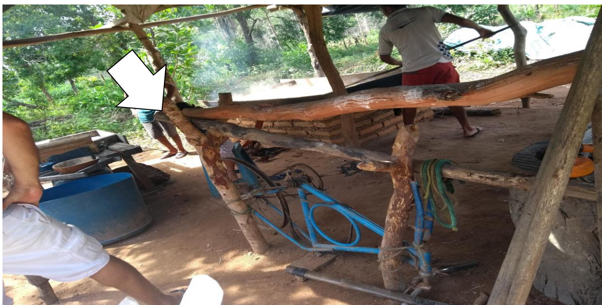
Figura 26 - Tecnologias sociais – triturador de mandioca movido a pedaladas
