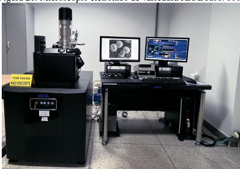
Figura 21: Microscópio eletrônico de varredura JEOL JSM7100F
