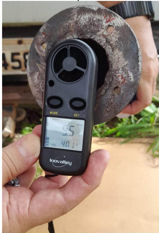
Figura 52: Velocidade e temperatura da vazão da mistura gasosa pré-uso das membranas compósitas
