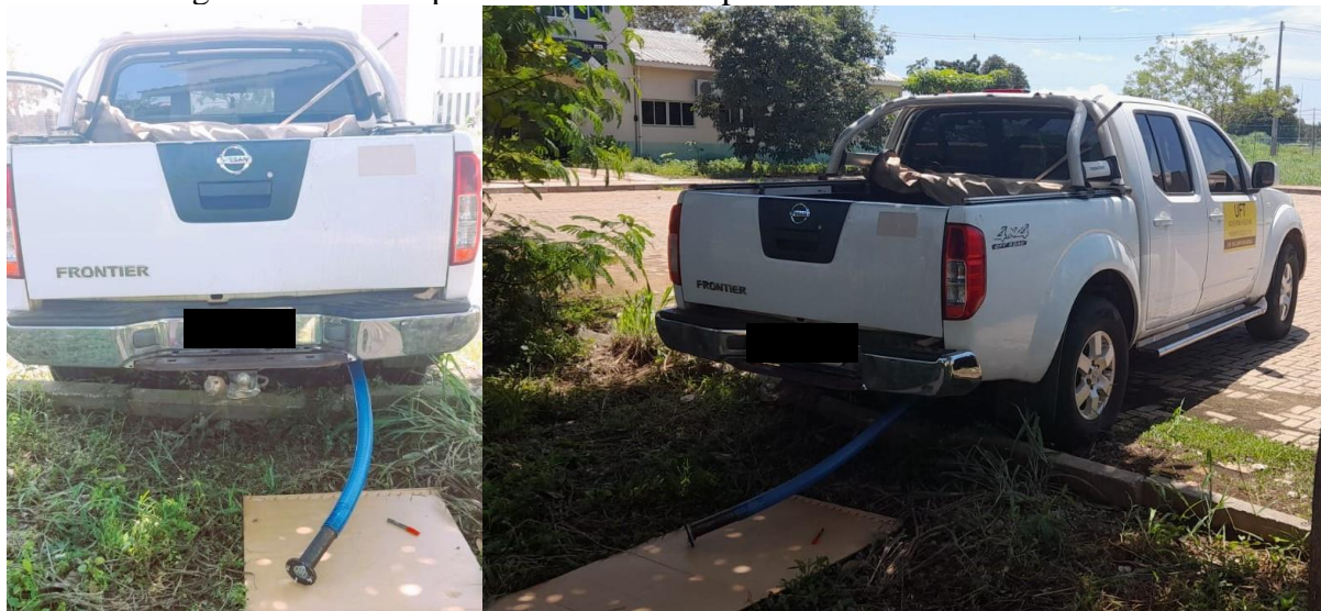
Figura 50: Coletor porta-membrana acoplado ao veículo Frontier S 4x4
