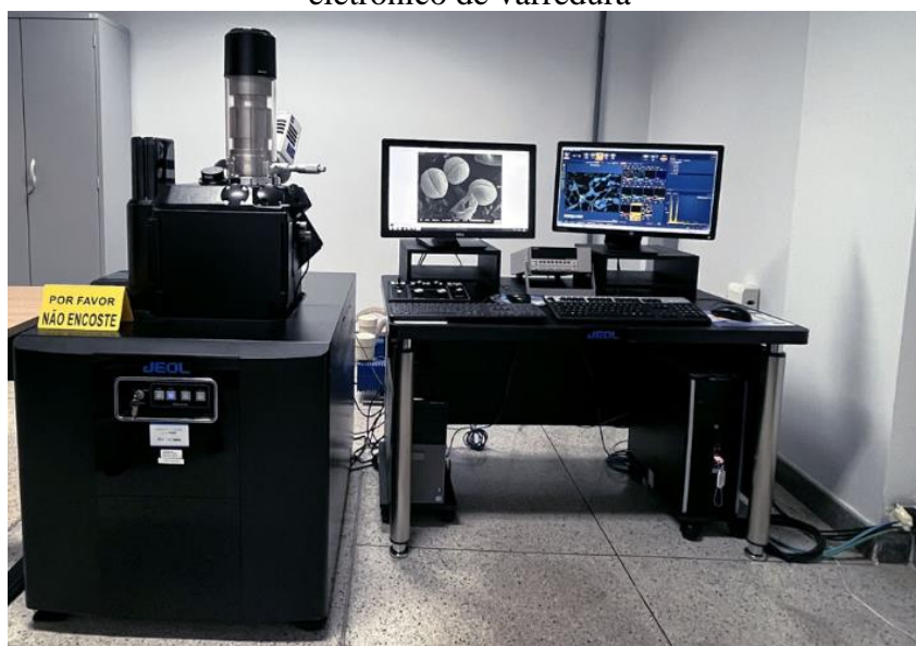
Figura 23: Detector de raios-X Oxford Instruments XMax-n 80 acoplado ao microscópio eletrônico de varredura
