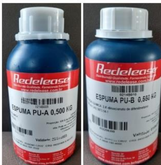
Figura 24: Componentes da espuma poliuretano (PU A associado ao PU B)
