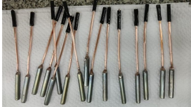
Figura 1. Eletrodo de trabalho em processo de construção.
