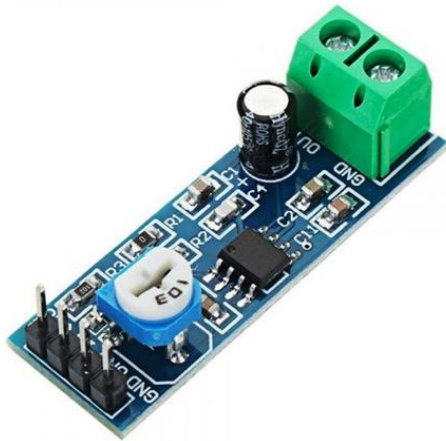
Figura 18. Módulo amplificador de áudio LM386.
