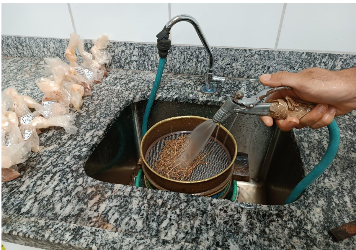
Apêndice H – Amostra de raiz sendo lavada em água corrente sobre peneira de 2 mm.
