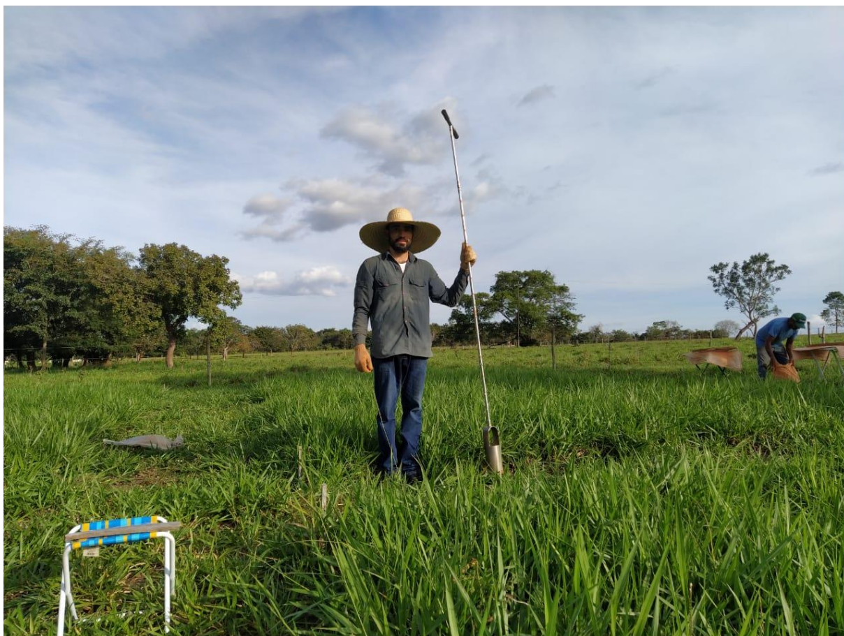
Apêndice E - Trado tipo caneco utilizado para amostragem de raiz e solo.
