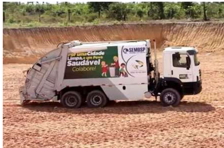
Figura 10 - Caminhão compactador utilizado na coleta dos resíduos sólidos em Santana do Araguaia, PA
