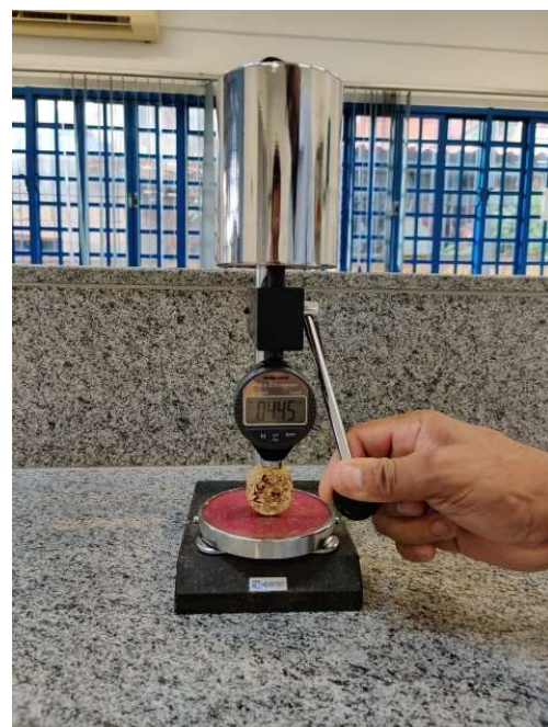
Figura 10 – a) Teste de dureza na superfície do briquete e b) teste de dureza na lateral do briquete
