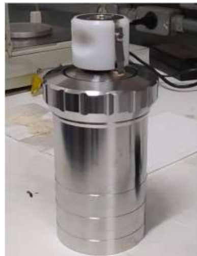
Figura 8 – a) cadinho inserido na estrutura em contato com o filamento e b) Recipiente contendo a amostra preparado para ser inserido na bomba calorimétrica
