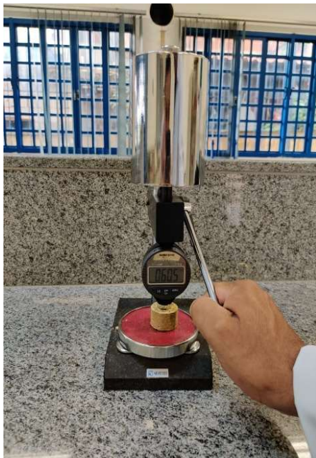
Figura 10 – a) Teste de dureza na superfície do briquete e b) teste de dureza na lateral do briquete
