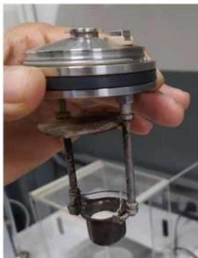
Figura 8 – a) cadinho inserido na estrutura em contato com o filamento e b) Recipiente contendo a amostra preparado para ser inserido na bomba calorimétrica
