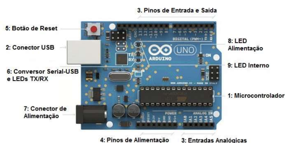
Figura 15: Componentes presentes em uma placa de Arduino [23].
