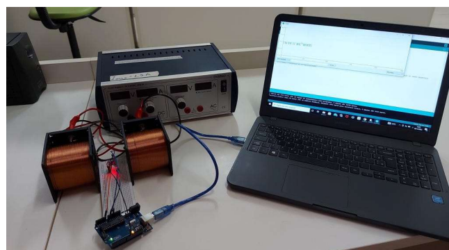
Figura 20: Aparato experimental no laboratório com bobina de multicamadas.
