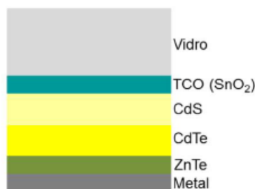
Figura 19 – Visão em corte de célula solar de filmes finos (Telureto de Cádmio) CdTe.
