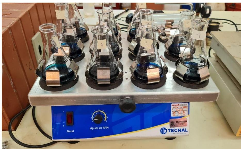
**Figura 5-7:** Ensaio de adsorção
