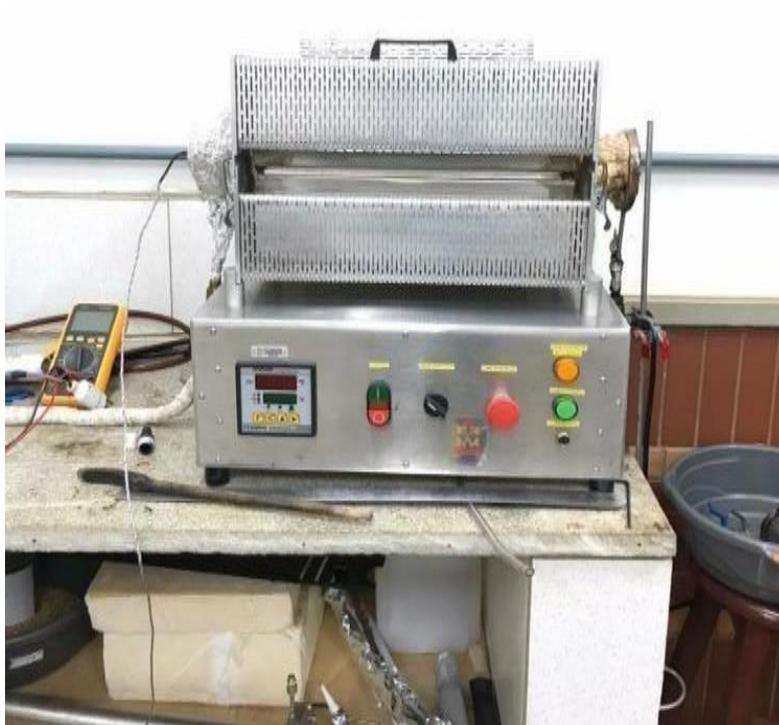
**Figura 5-4:** Reator empregado no ensaio da Pirólise
