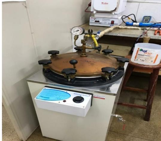
**Figura 5-5:** Autoclave empregado na geração de vapor aquecido
