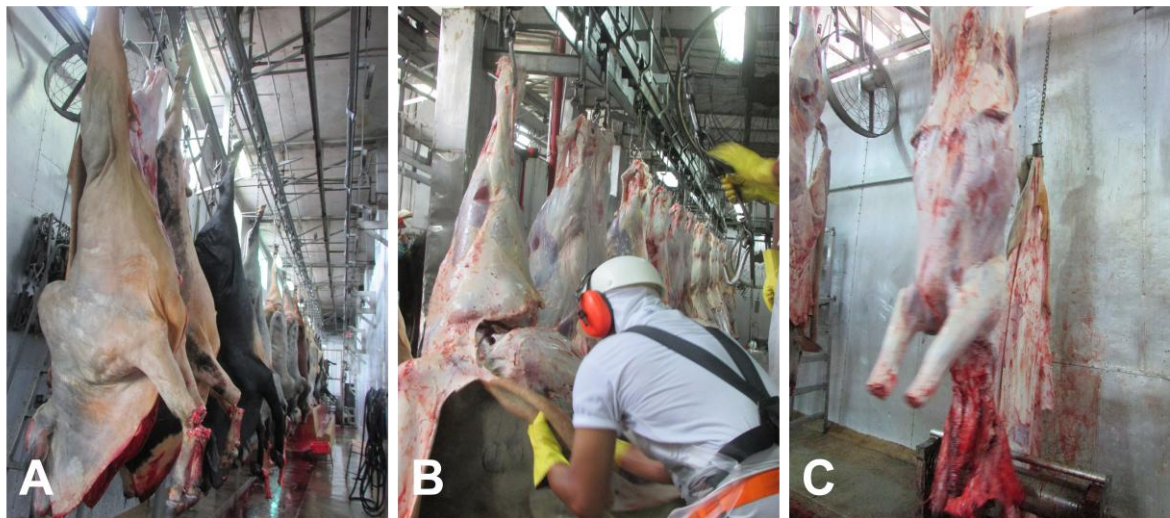
Figura 13 Esfolação da lateral superior direita e desarticulação dos mocotós (A); Esfolação da lateral superior esquerda (B); Retirada do couro no rolete (C). Fonte: Arquivo da empresa Boi Forte Frigoríficos Ltda, 2017.
