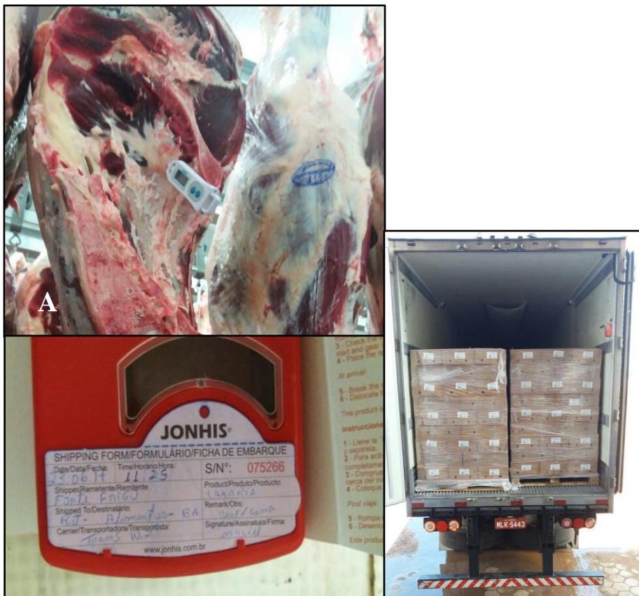
Figura 17: A – Controle de temperatura da carcaça; B –Termógrafo; C – Termógrafo instalado no caminhão;
