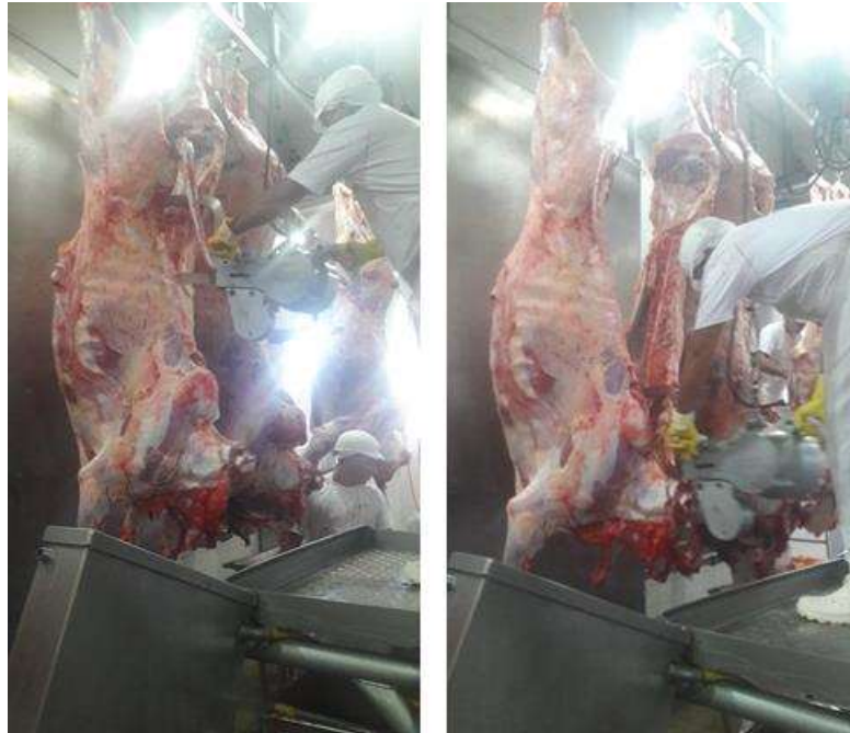
Figura 16 – Carcaça sendo dividida ao meio com o auxílio de uma serra elétrica – Matadouro-Frigorífico ASSOCARNE, 2017.
