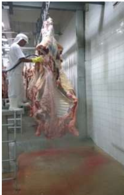
Figura 18 – Lavagem das meias carcaças com água clorada – Matadouro-Frigorífico ASSOCARNE, 2017.
