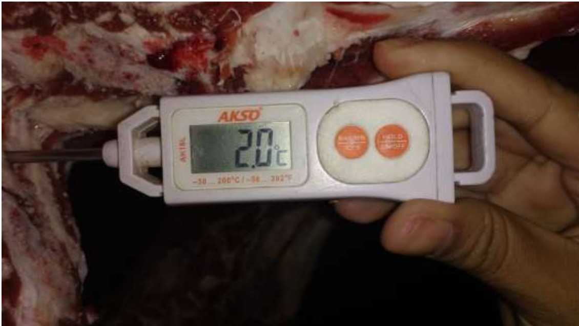
Figura 22 – Aferição da temperatura antes de se iniciar o carregamento – Matadouro-Frigorífico ASSOCARNE, 2017.
