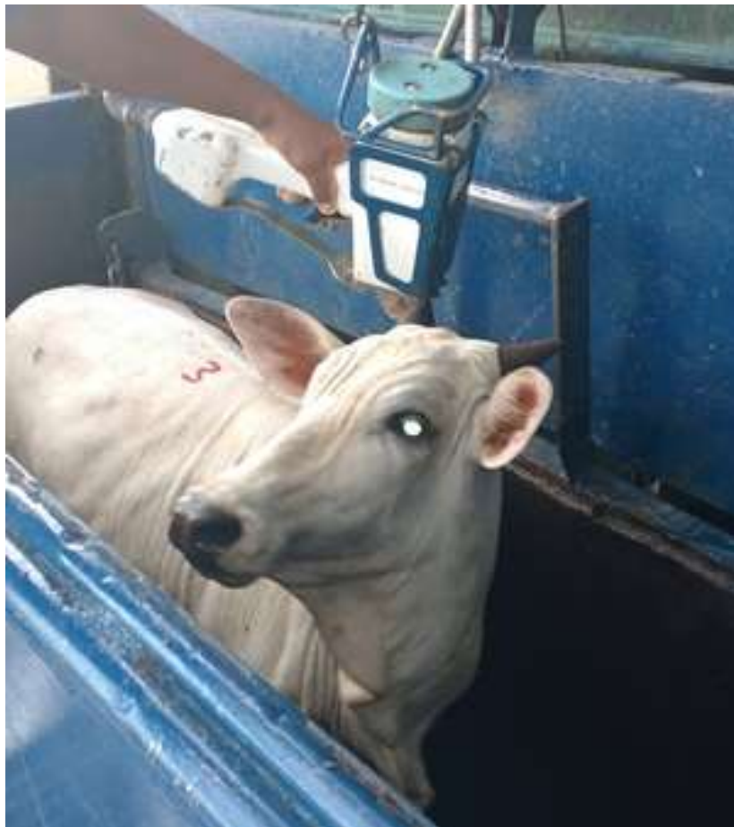
Figura 04 – Momento da insensibilização com a Pistola Pneumática – Matadouro-Frigorífico ASSOCARNE, 2017.
