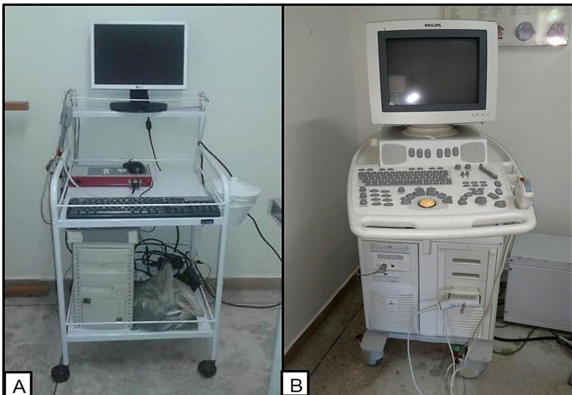
**Figura - 4 A:** aparelho de eletrocardiografia e **B:** Aparelho para ultrassonografia.
