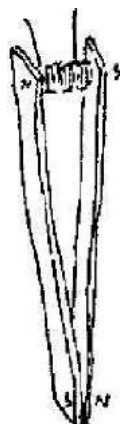
Figura 45: Pinça formada por dois ímãs: para obter corrente induzida pela ação de um ímã permanente.
