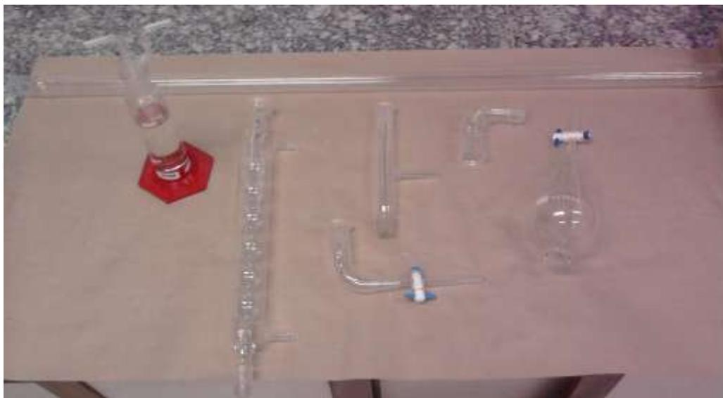
**Figura 1.** Tubo de quartzo e vidrarias que compõem o sistema de pirólise.
