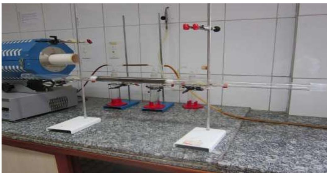
**Figura 2.** Tubo reator de quartzo com amostra antes da pirólise.
