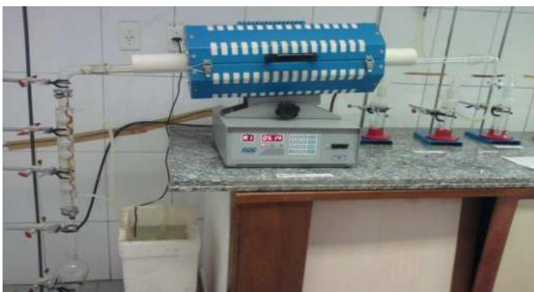
**Figura 3.** Sistema de pirólise completo em funcionamento.
