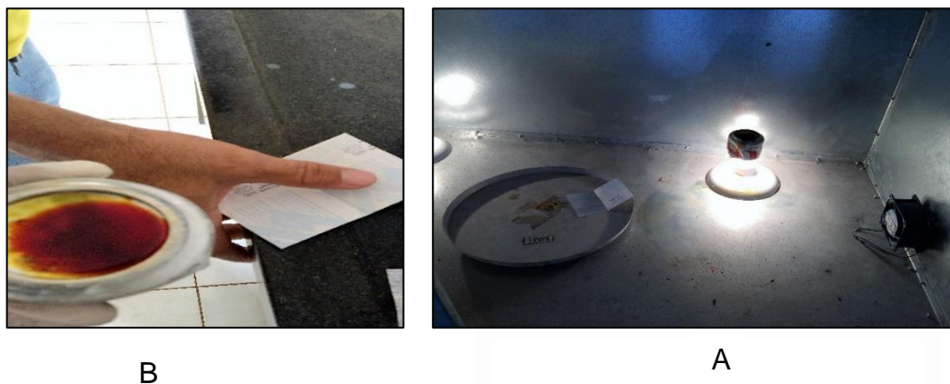
Figura 21 - O preparo do Iodo líquido a 2%, do papel (A) e da câmara de vaporização (B), para posterior processo de queima do mesmo.
