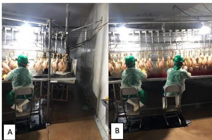
Figura 5 – Processo de insensibilização e sangria no Abatedouro
