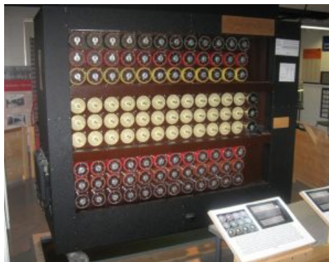
Figura 3.7: Máquina Bombe auxiliava na decodificação de mensagens secretas alemãs
