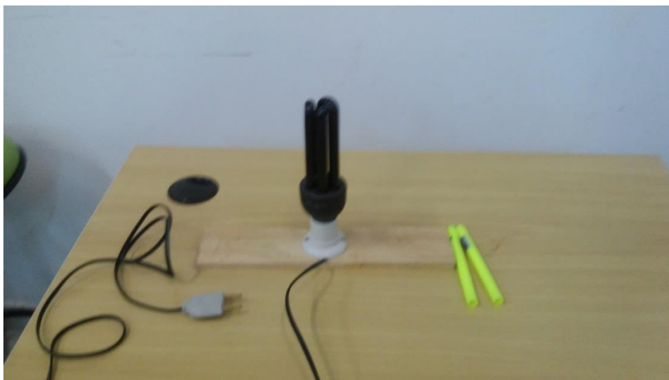
Figura 3.1 Experimento de Luminescência montado. Acompanhando de canetas marca texto que é um material que luminesce na presença dos raios UV-A
