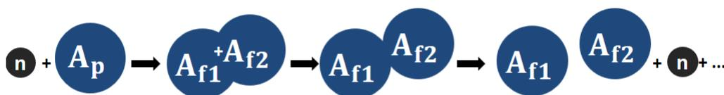
Figura 3.1: Representação do processo de fissão nuclear induzida onde  $A_p$  é o núcleo pai,  $A_{f1}$  fragmento um,  $A_{f2}$  fragmento dois e  $n$  é o nêutron.
