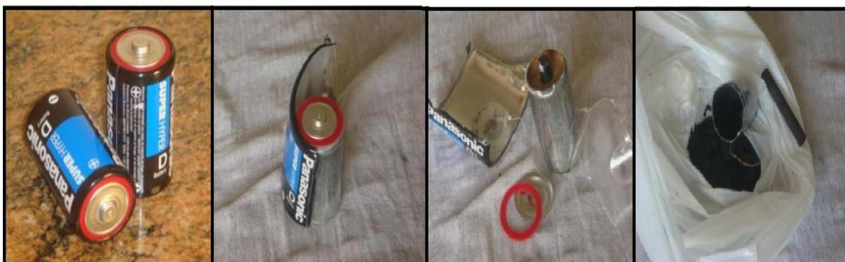
**Figura 08:** Processo de extração do carbono (grafite) de pilha.
