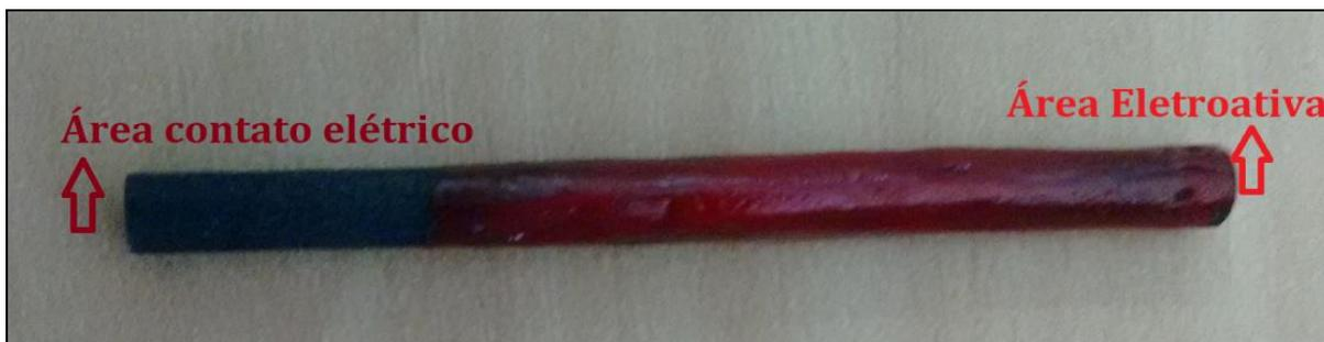
**Figura 10:** Foto do Eletrodo de Trabalho confeccionado a partir de pilhas descartadas.
