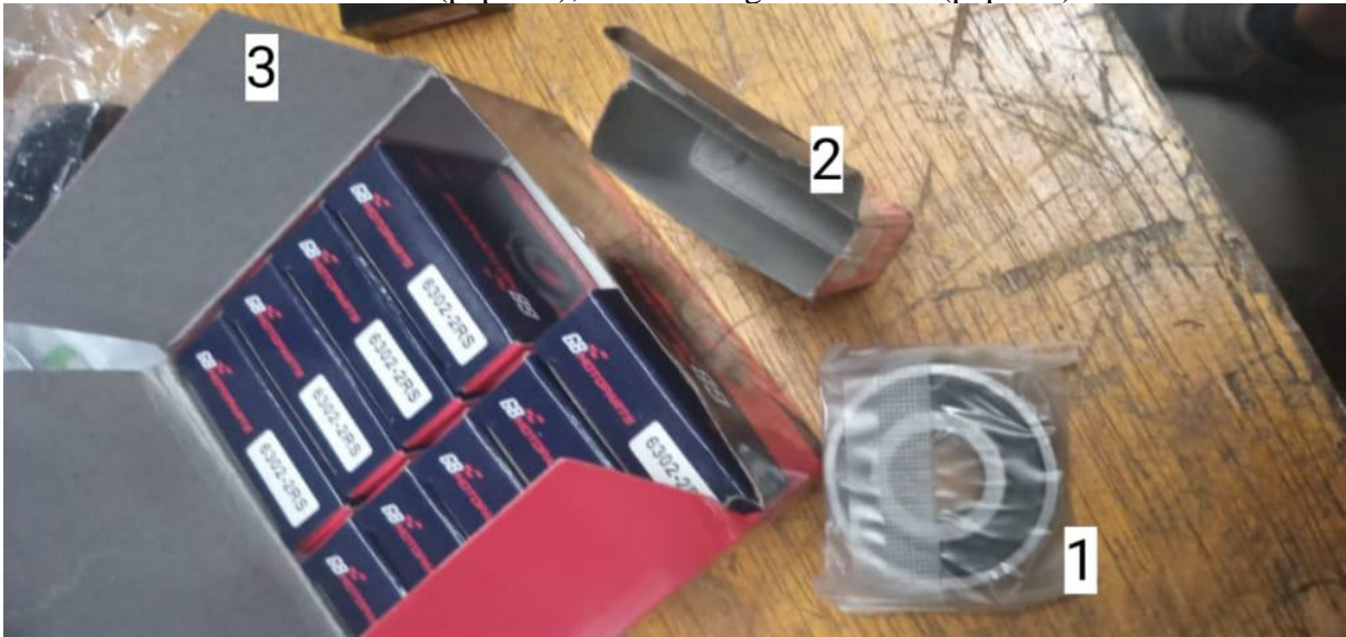
Figura 06 –Estrutura das embalagens: 1 -embalagem primária (plástico); 2 -embalagem secundária (papelão); 3 – embalagem terciária (papelão)
