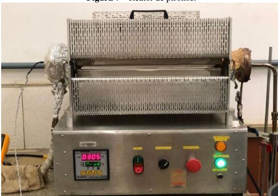
Figura 7 – Reator de pirólise.
