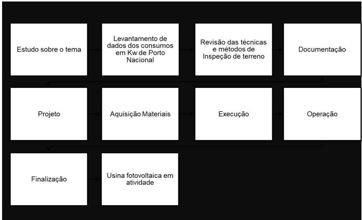
Figura 7 – Sequência de atividades para implantação da usina fotovoltaica em Porto Nacional-TO
