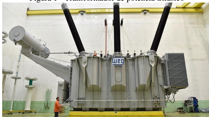
Figura 1 - Transformador de potência trifásico
