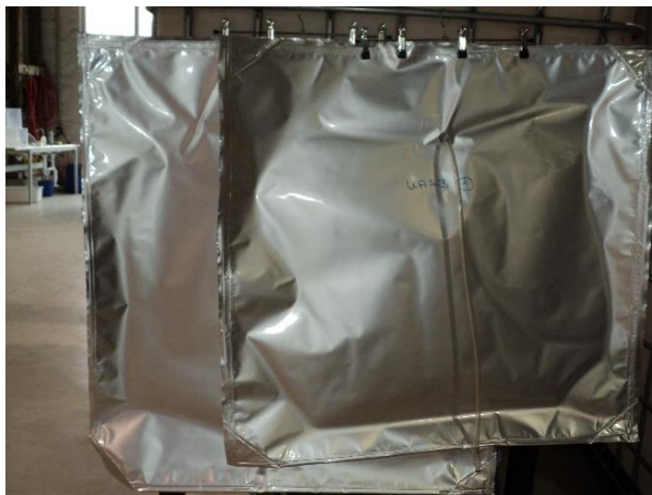
Figura 2. Sacolas usadas para armazenamento de biogás em escala laboratorial (O autor, 2015).
