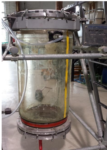
Figura 1. Reator UASB utilizado no experimento (O autor, 2015).
