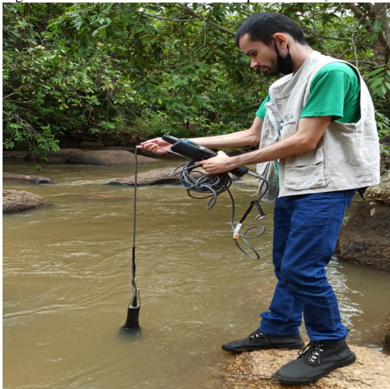
Figura 9 – Manuseio da Sonda Multi-parâmetros (YSI 6920).
