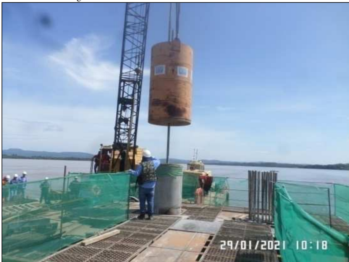
Foto 5: Prova de carga Dinâmica- PDA
