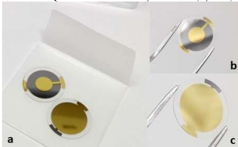
Figura 5 - Cristal de Quartzo revestido de ouro. a) frente e verso; b) frente; c) verso
