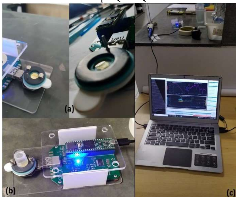
Figura 6- Sequência de montagem da microbalança de cristal de quartzo (QCM). a) Câmara de reação com o cristal de quartzo acoplado; b) QCM-D; c) Computador operando com o software OpenQCM-Q1.
