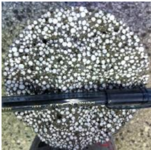
Figura 6 – Estrutura interna do concreto leve estrutural com pérolas de EPS
