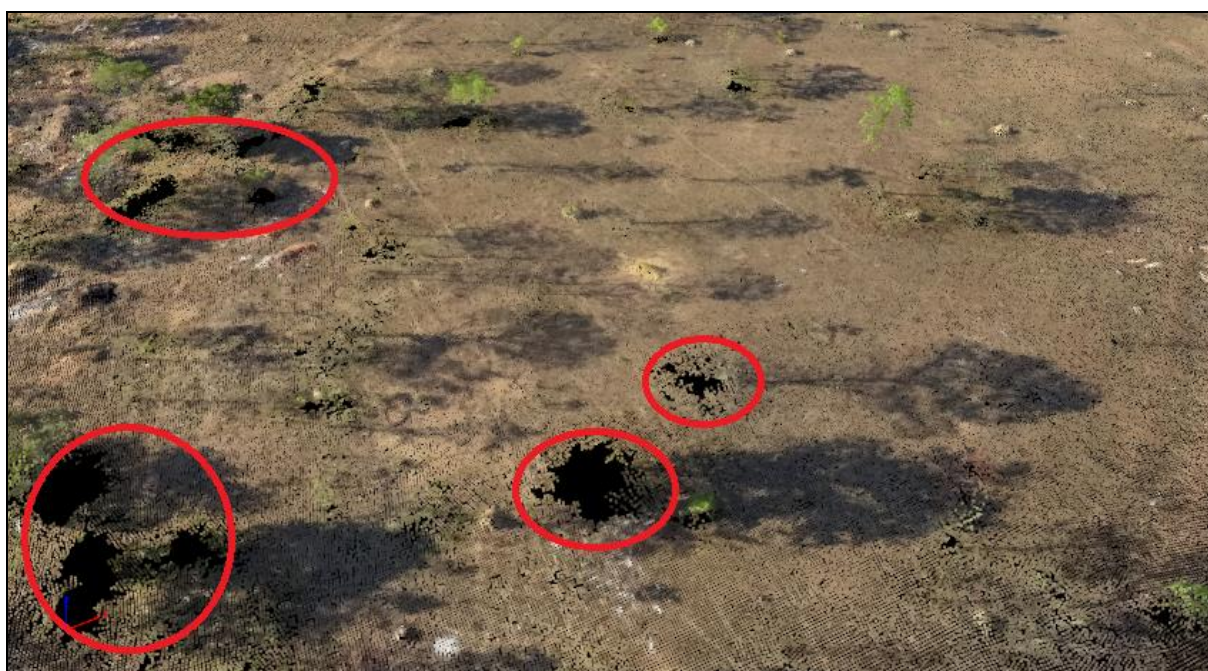
Figura 24. Falhas na formação da nuvem de pontos do MDS. (Fonte: autor)
