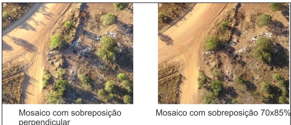
Figura 27. Mosaicos com trajetória perpendicular e sobreposição de 70x85% nas coordenadas 10°21'15,30"S e 48°15'47,69"O. (Fonte: autor)
