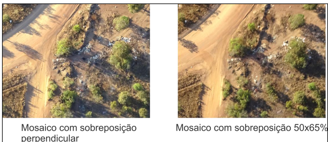
Figura 26. Mosaicos com trajetória perpendicular e sobreposição de 50x65% nas coordenadas 10°21'15,30"S e 48°15'47,69"O. (Fonte: autor)
