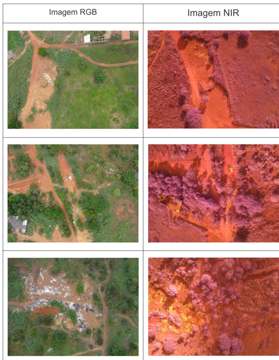
Figura 19. Resultados de imagens de um mesmo ponto obtidas com sensor RGB e NIR. (Fonte: autor)
