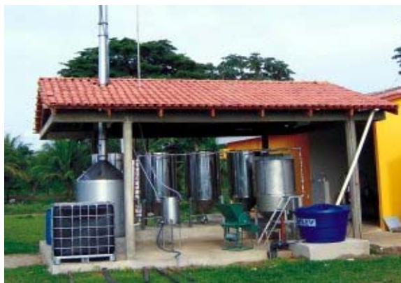
FIGURA 2 - Sistema piloto de destilação de etanol com capacidade de 150 litros/dia. FONTE: Lasper/UFT, 2006.
