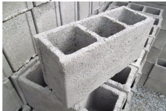
Figura 07 - Blocos de concreto
